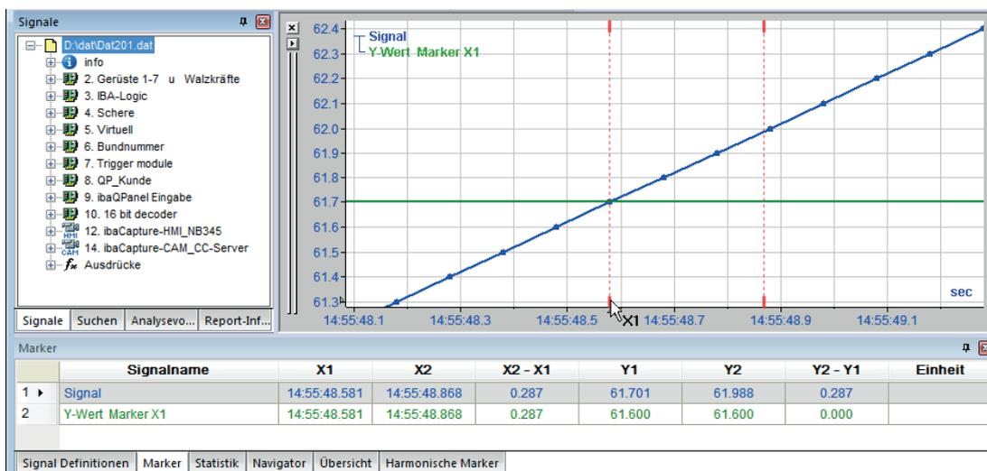
Рис. 36: «Улавливание» точки сигнала
