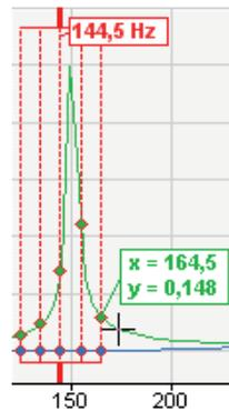
Harmonische und Seitenbandmarker können auch kombiniert angezeigt werden. Die Abbildung unten zeigt eine Ansicht mit einem harmonischen Marker unter und zwei über dem Hauptmarker. Der Offset des Seitenbands ist eingestellt auf 10 Hz.
