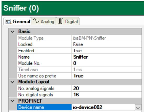
Figure 5: ibaPDA Sniffer module „General“ tab
