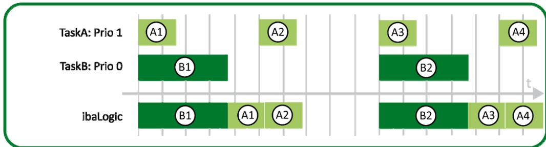
Abbildung 125: Taskberechnung mit Verdrängung
