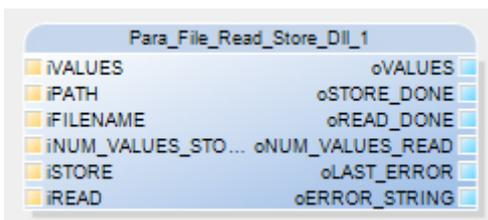
Abbildung 76: Para\_File\_Read\_Store\_DII als Funktionsbaustein im Programm
