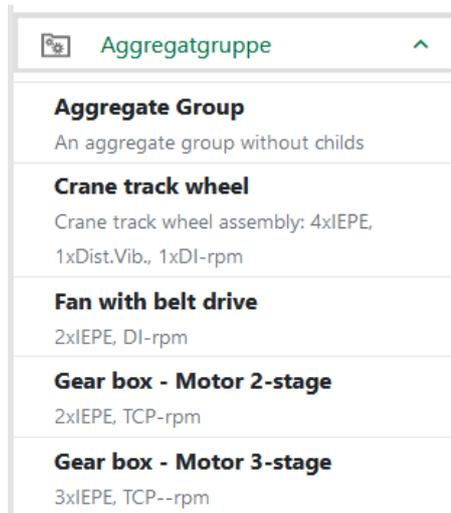
Sie können entweder eine leere Schablone namens **Aggregate Group** verwenden, oder eine, die bereits Daten enthält, wie z. B. **Gear box - Motor 2-stage**. Generell ist es immer günstig, die Vorlage auszuwählen, die möglichst nahe an der realen Konfiguration liegt, damit der Anpassungsaufwand möglichst gering ist.
