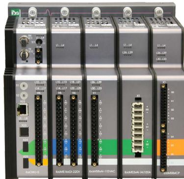
Die Condition Monitoring Unit (CMU) ist die Mess- und Auswerte-Hardware für Condition Monitoring-Anwendungen, die auf Schwingungsmessung basieren. An eine CMU können mehrere Module angeschlossen werden. Dabei gibt es Module zum Aus- und Einlesen von Digitalsignalen, Analogsignalen und Schwingungssensoren. Über das TCP/IP-Kommunikationsprotokoll werden Prozessdaten (z. B. Drehzahl, Gewicht, Drehmoment, ...) mit der Automatisierungsumgebung (z. B. SPS) ausgetauscht.
