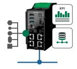
Mit Edge Analytics-Anwendungen lassen sich Prozesse messdatenbasiert lokal in Echtzeit überwachen. Die lokal erfassten Prozessdaten können autonom direkt dort verarbeitet werden, wo sie entstehen. Eine konfigurierbare Alarmierung bzw. Ausgabe an Steuerungen ermöglichen unmittelbare Reaktionen auf Abweichungen. Ergebnisse und Kennwerte können prozesssynchron einfach und sicher in Cloud-Infrastrukturen integriert werden.
